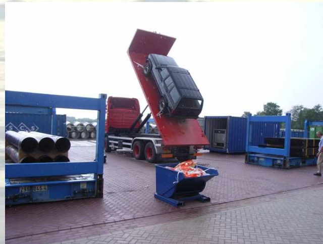
Beispiel: Ladungssicherung Praxistest
