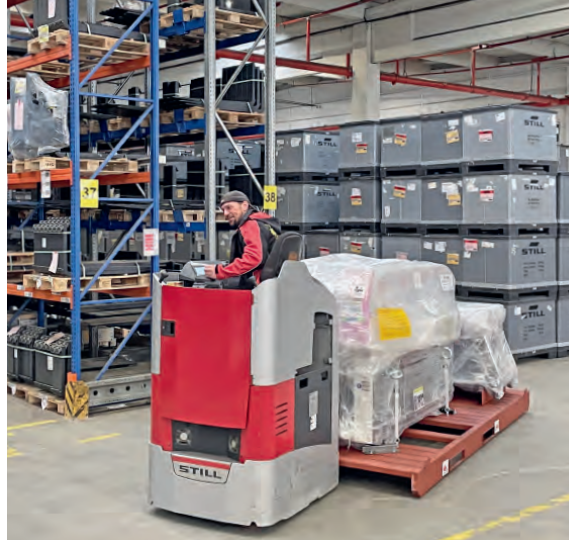
Elektromobilität bei Pfaff: Für Transporte im Lager kommt ein FS-X-Niederhubwagen von Still zum Einsatz. Der Kraftprotz hebt bis zu fünf Tonnen und heißt intern nur „das Monster“.
